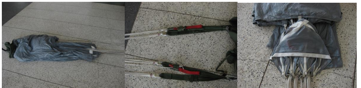
๒. การพับผืนผ้าร่ม พับแผ่นควบคุมการกาง เก็บสายบังคับ
