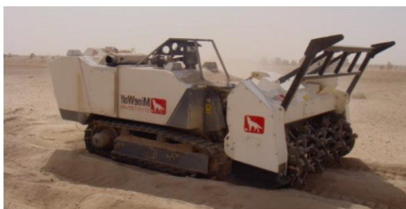
ลักษณะหัวกวาดล้างเป็น Tiller (หัวเจาะแบบส้อม)
